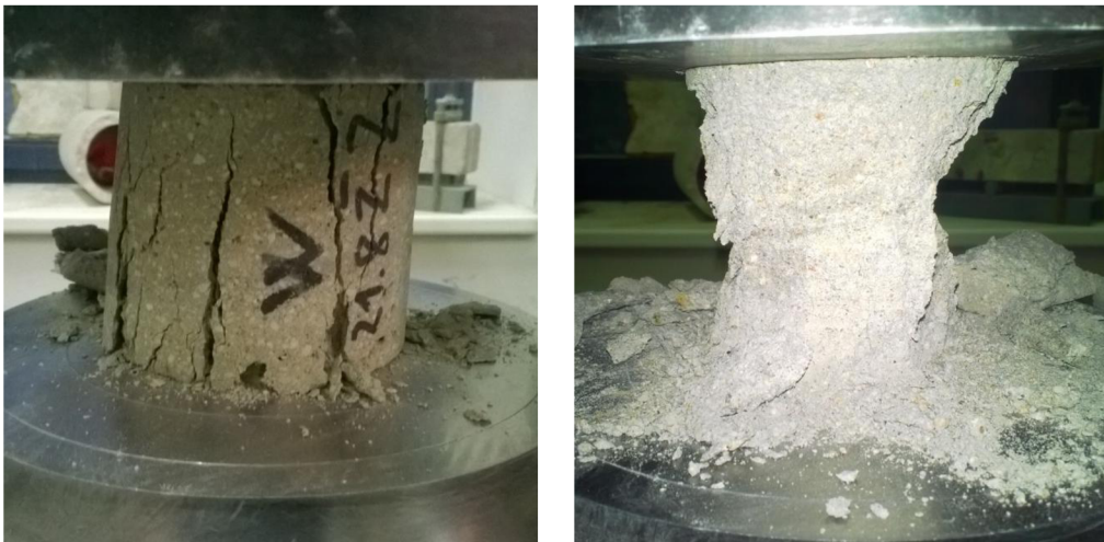
Obrázek 22: průběh zkoušky pevnosti v tlaku
