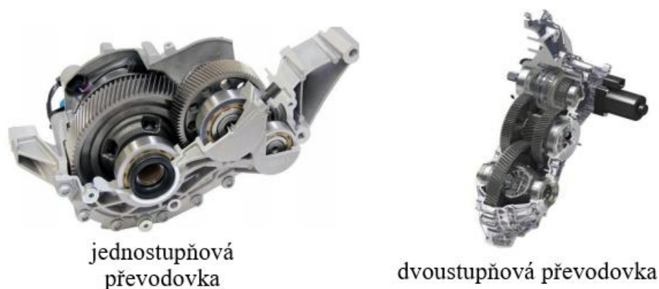
Obr. 25 Převodová ústrojí elektrických vozidel [34]
