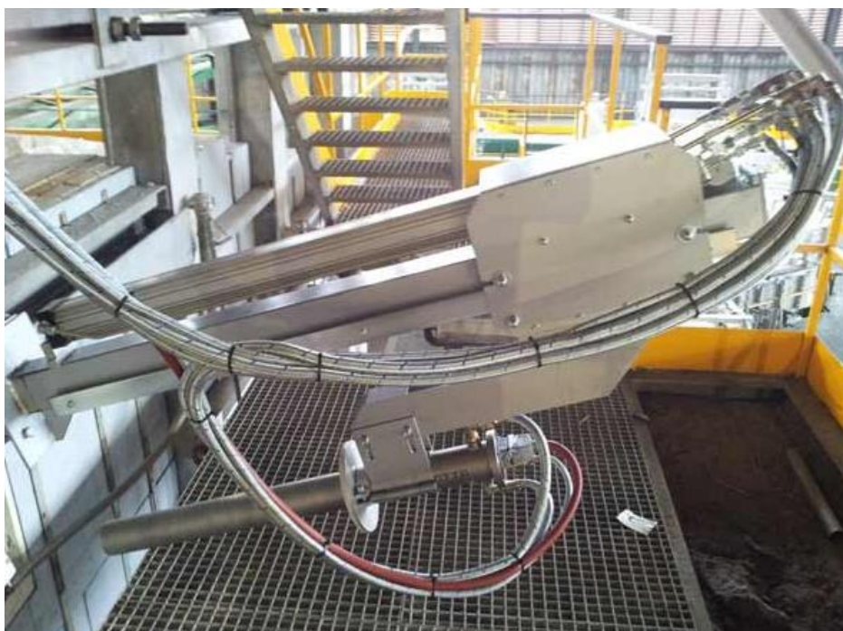
Obrázek 23 Termokamera DIAS, PYRONIC určena pro spalovací komory. [61]
