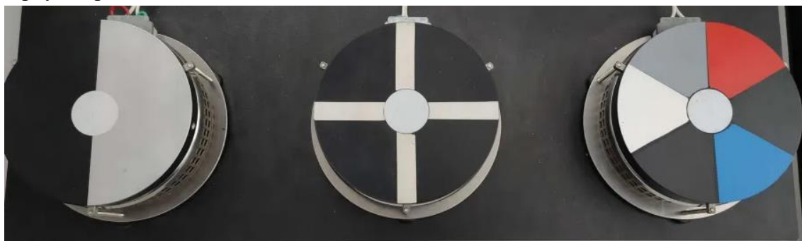
Obrázek 36 Přípravek s plotýnkami využitý pro měření vlivu emisivního součinitele.
