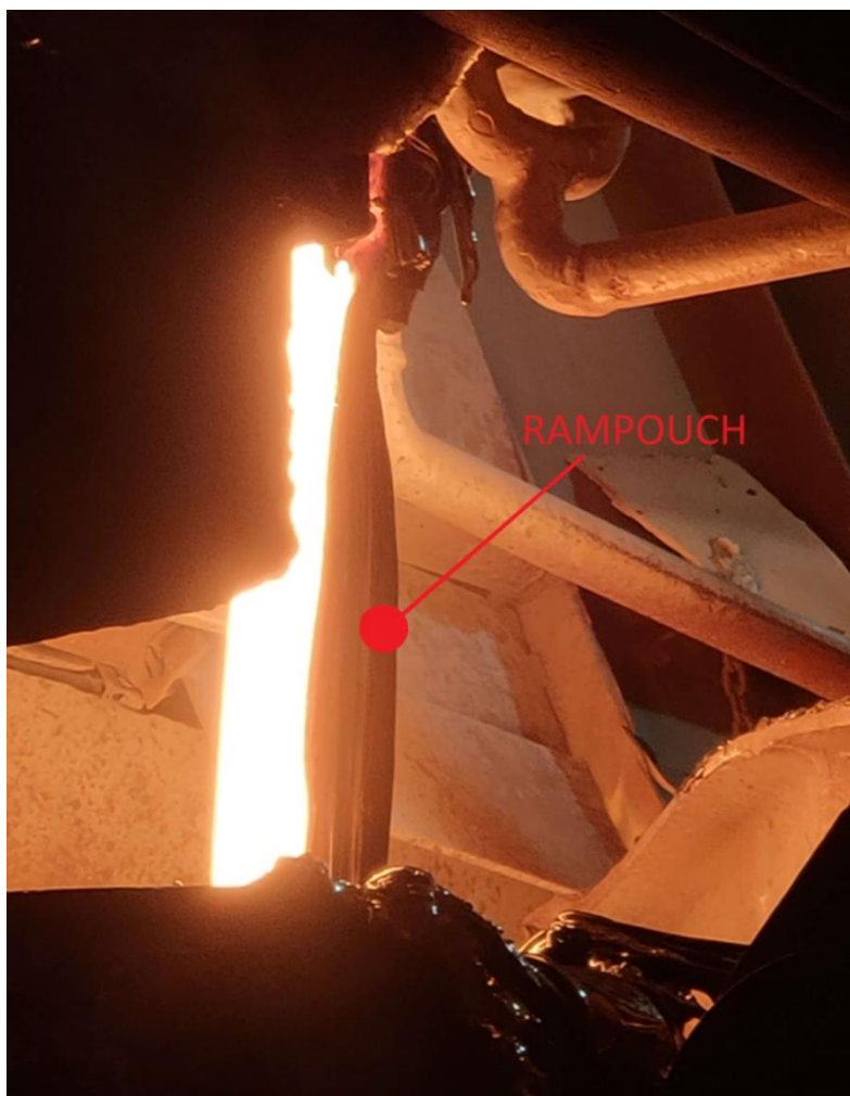
Obrázek 41 Fotka „rampouchu“ vytvořeného na výtokovém žlabu pece.
