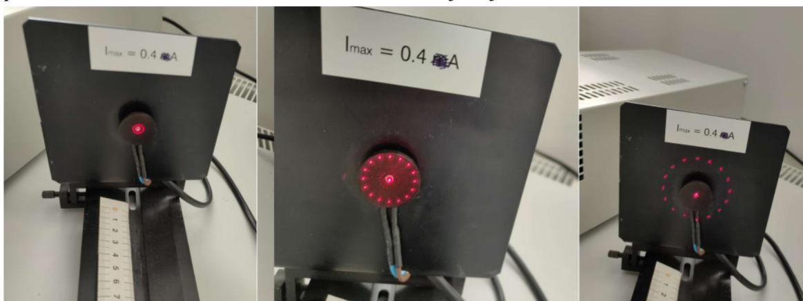
Obrázek 35 Zorné pole snímače Raytek MX ve vzdálenosti 30 cm (vlevo), ve vzdálenosti 10 cm (uprostřed) a ve vzdálenosti 80 cm (vpravo)
