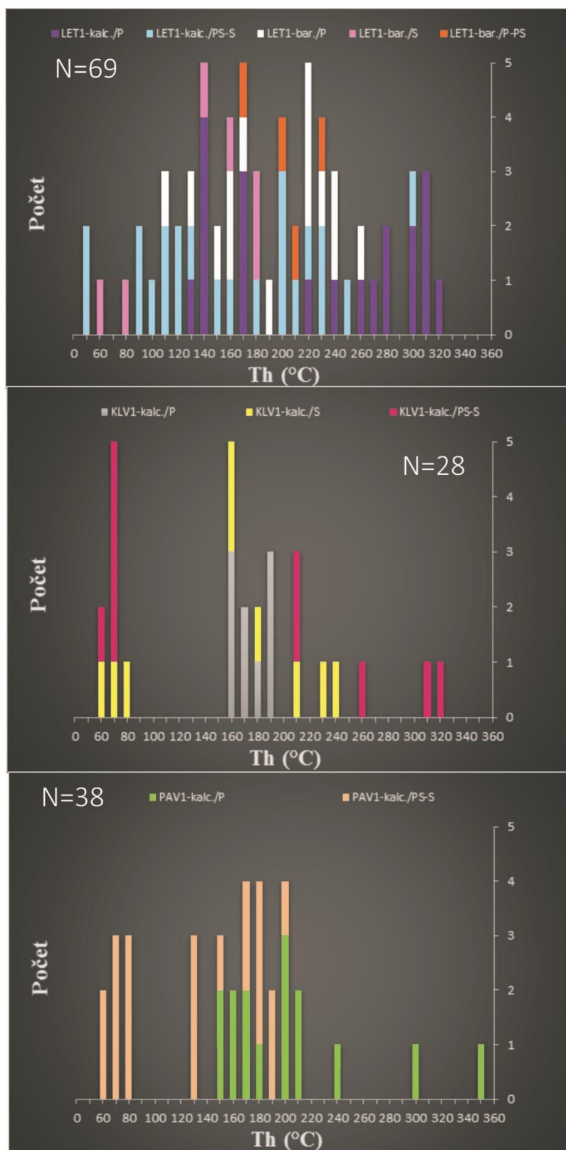
Obr. 24 – Histogramy četnosti teplot homogenizace ( Th ) v L+V fluidních inkluzích ve vzorcích ze zájmových lokalit. LET1 – lokalita Letovice, KLV1 – lokalita Klevetov, PAV1 – lokalita Přední Arnoštov. Kal – kalcit, bar – baryt.
