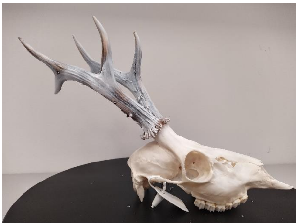
Obrázek 12 Antireflexní nástřík na skenované paroží
