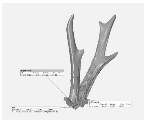
Obrázek 19 Měření délky lodyhy naskenovaného objektu
