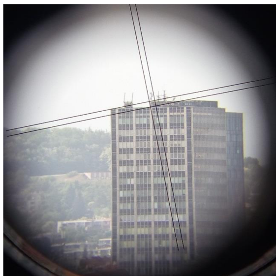
Obr. 4.11: Doladění pomocí dalekohledu – anténa Master
