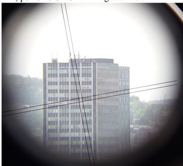
Obr. 4.12: Doladění rádia na straně Hotelu pomocí Aiming tool
