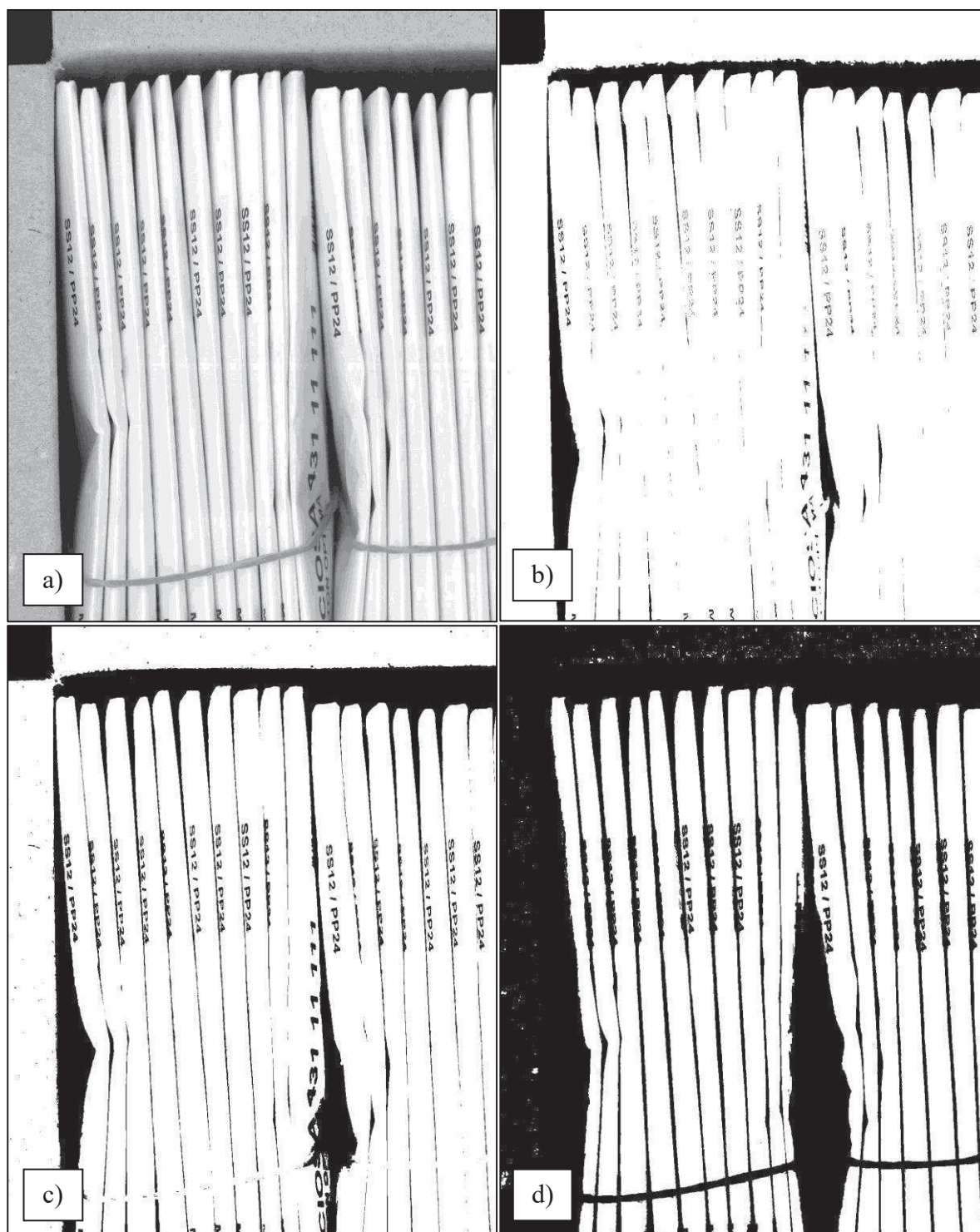
Obrázek 7 – Případy různého prahování, které vzniknou ze a) zdrojového obrazu, který je ve stupních šedi. Na obrázku b) je vidět použití příliš nízkého prahu odpovídajícímu prvnímu kvantilu, čili i mezery mezi obálkami se staly světlými. Obrázek c) má již lépe viditelně rozlišeny obálky a například gumička je stále nad prahem, který byl zvolen v hodnotě druhého kvantilu, mediánu hodnot. V obrázku d) je práh již natolik vysoko (hodnota třetího kvantilu), že i víka krabice mají výslednou černou barvu.
