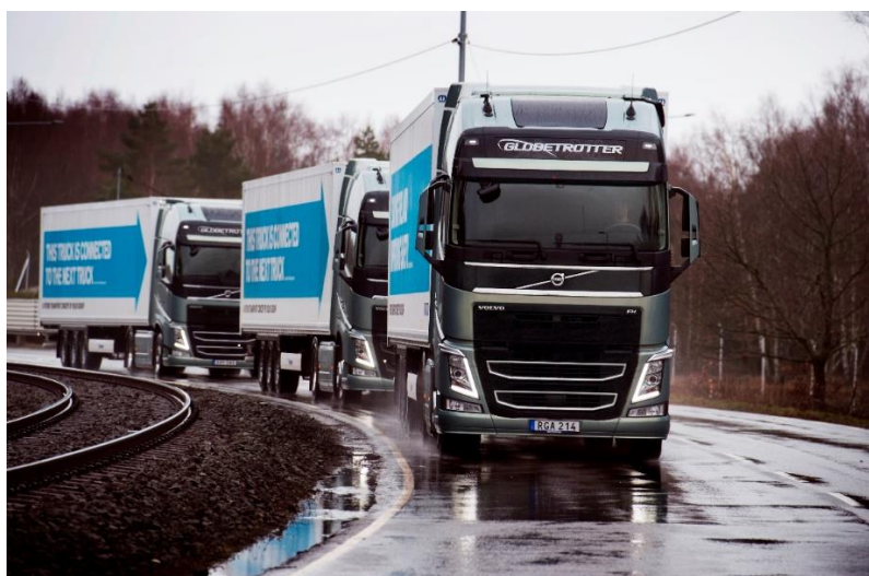
Obr.8 Zkušební automatizovaný konvoj společnosti Volvo Trucks [17].
