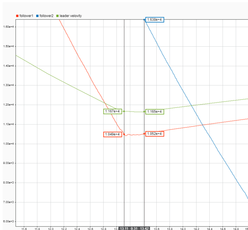
Obr.46 Detail grafu s vyznačeným rozdílem mezi začátkem akcelerace sestavy leader a follower1.
