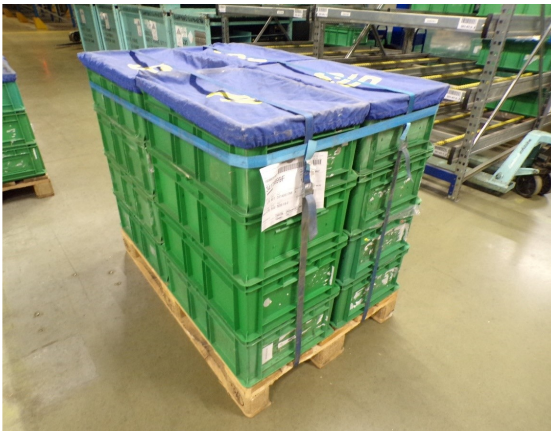
Obr. 3.8 Ukázka interních bedýnek na paletě pro JIS sklad
