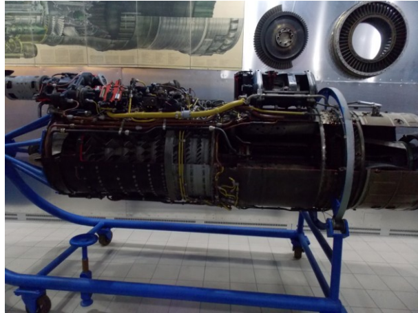
Obr. 19 Proudový motor Tumanskij RD-9B
