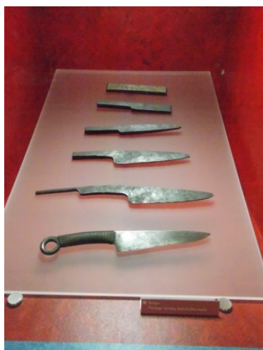
Obr. 61 Kreps – postup výroby keltského nože
