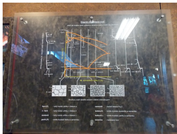
Obr. 66 Diagram krystalizace oceli
