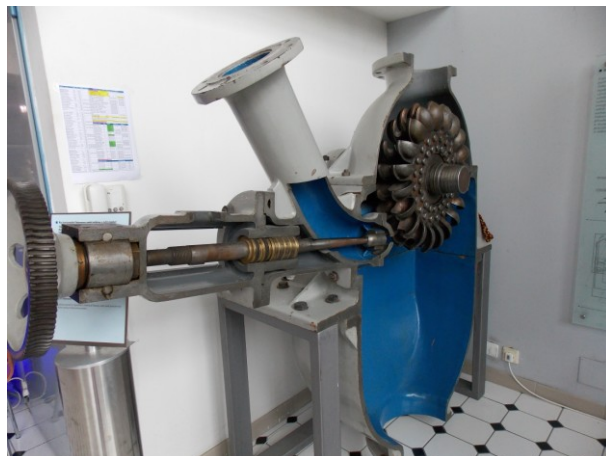
Obr. 14 Řez horizontální Peltonovou vodní turbínou s ruční regulací
