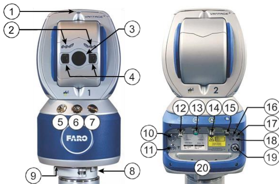
Obr. 9: Popis hlavních součástí na přístroji Laser Tracker FARO Vantage [4]
