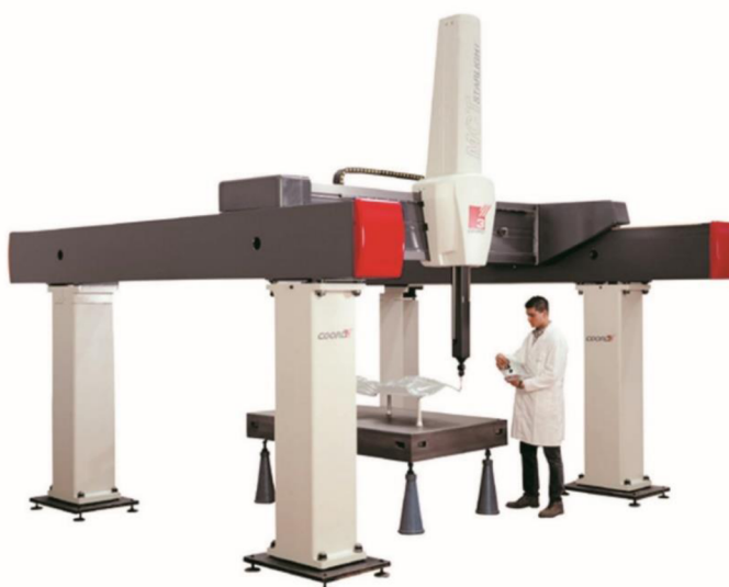
Obr. 3: Mostový souřadnicový měřicí přístroj COORD3 MCT NT [2]
