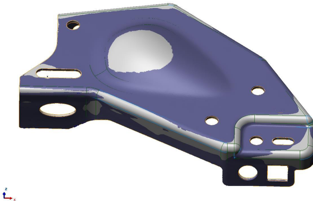
Obr. 27: Vyrovnání skenu na CAD model metodou Best-fit - autor
