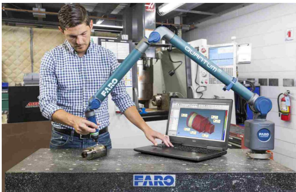
Obr. 5: Mobilní souřadnicový měřicí stroj FaroArm Quantum M [2]
