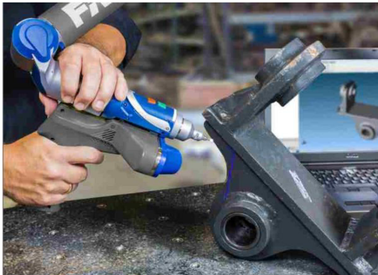
Obr. 8: Mobilní souřadnicový měřicí stroj FaroArm s laserovým liniovým skenerem [2]
