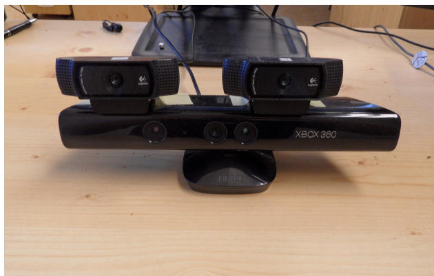
Obrázek 9.2: Microsoft Kinect a dvě kamery Logitech C920 použité k nahrávání.
