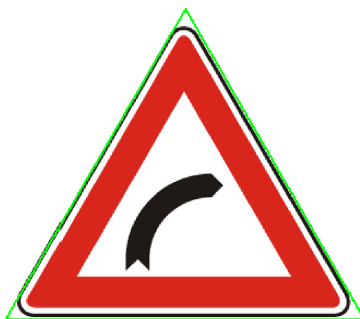
Obr. 22 – Detail malého trojúhelníku, umístěného na rastru na obvodu dopravní značky
