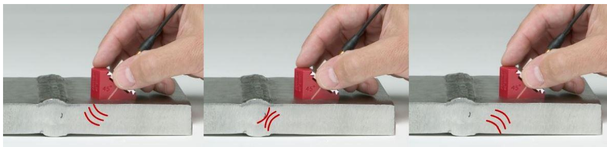
obr. 1.19. Skúšanie zvaru odrazovou metódou, pri použití uhlovej sondy [20]
