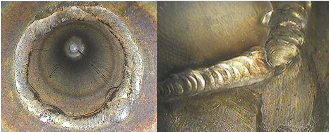
obr. 1.6. Kontrola zvarového spoja pomocou videoskopov [9], [10]
