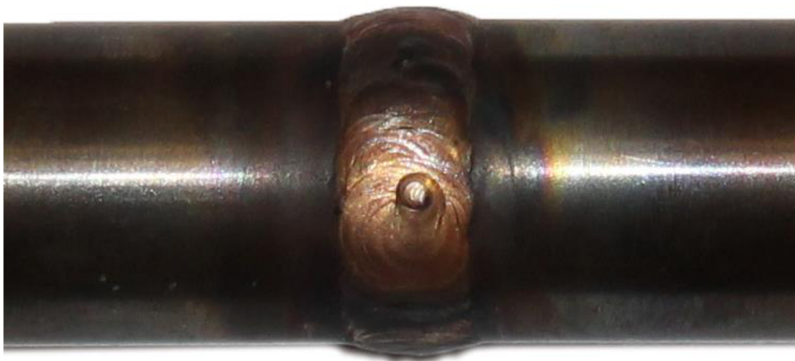
obr. 4.1. Vizuálna kontrola zvaru
