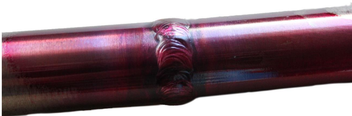
obr. 4.2. Nanosenie penetračnej kvapaliny
