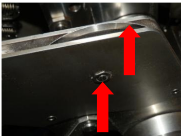
Obrázek č. 16: Hrana podélného nože, středový šroub s ložiskem, vlastní zdroj
