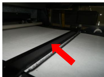
Obrázek č. 40: Krytka UV-lampy, vlastní zdroj
