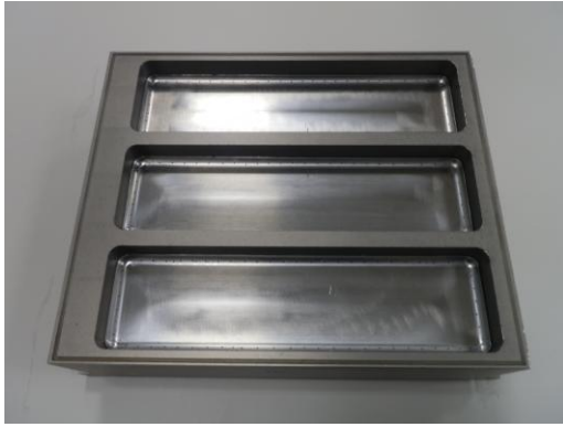
Obrázek č. 7: Tvarovací forma vaničky M3L, vlastní zdroj
