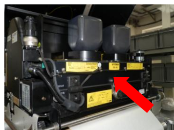
Obrázek č. 30: Mixing unit, vlastní zdroj
