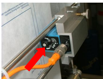
Obrázek č. 34: Čidlo pro tiskovou značku, vlastní zdroj
