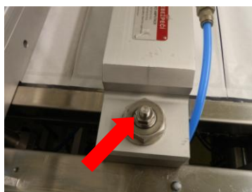
Obrázek č. 20: Matka pro povolení hlavy nože, vlastní zdroj
