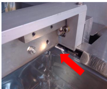
Obrázek č. 23: Zbytky odřezků přichycené k vedení řetězu, vlastní zdroj
