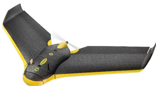
Obrázek 8: Dron eBee X (AgEagle, 2012)
