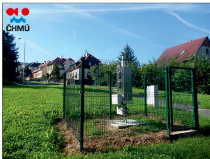
Obrázek č. 9 - Stanice MIM Karlovy Vary - vzorkovač suspendovaných částic PM_x ve venkovním ovzduší, zdroj ČHMÚ
