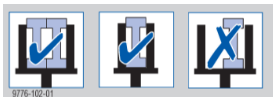
Obrázok 9- Správne osadenie pozdĺžnych nosníkov do spúšťacích hlavíc [ 6]
