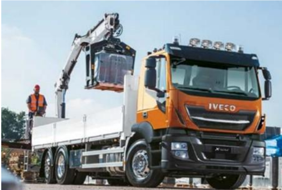
Obrázok 12- Nákladný automobil IVECO Stralis X-WAY 6x2 s hydraulickou rukou [ 18]
