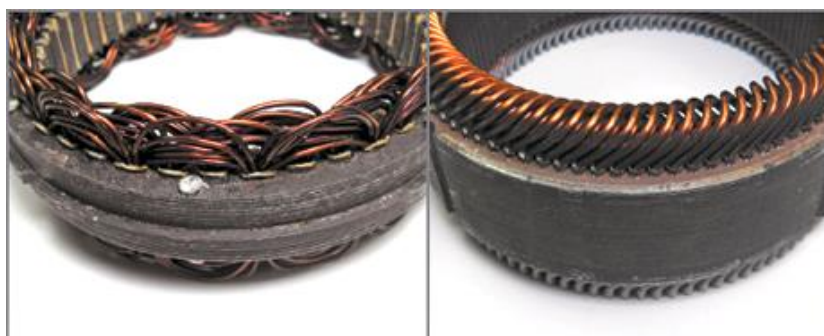
Obr. 14: Uloženie satorových vinutí; vľavo ručne vinuté, vpravo flat pack [7]
