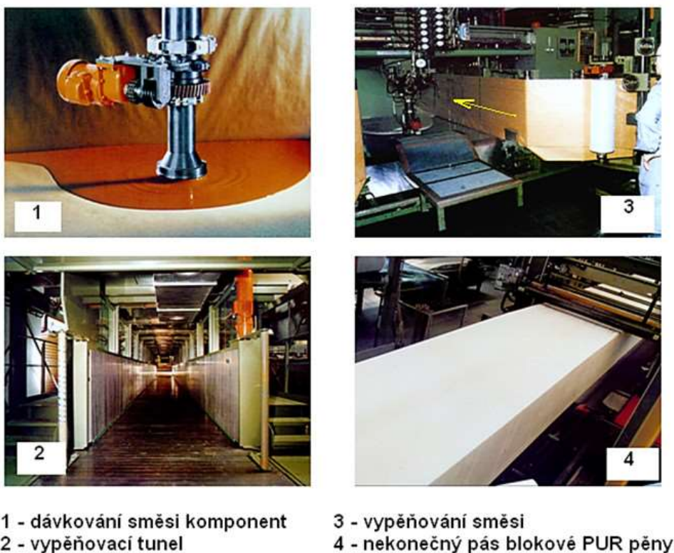
Obr. 6: Zařízení na vypěňování PUR pěny kontinuální technologií dle [16]
