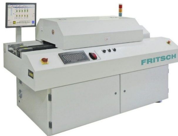
Obr. 2: Přetavovací pec Fritsch [12]
