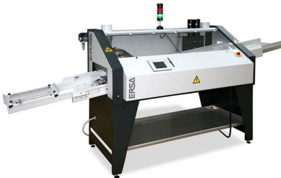
Obr. 3: Ersal, zařízení pro pájení vlnou [13]
