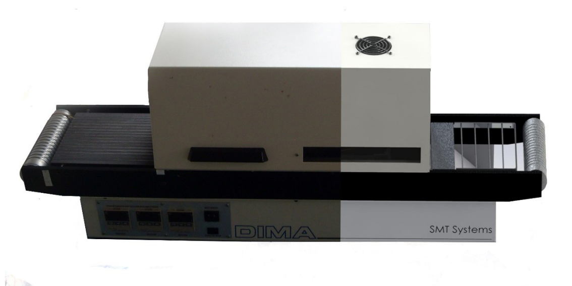
Obr. 15: Přetavovací pec DIMA Smro 0180 (3D model vpravo)
