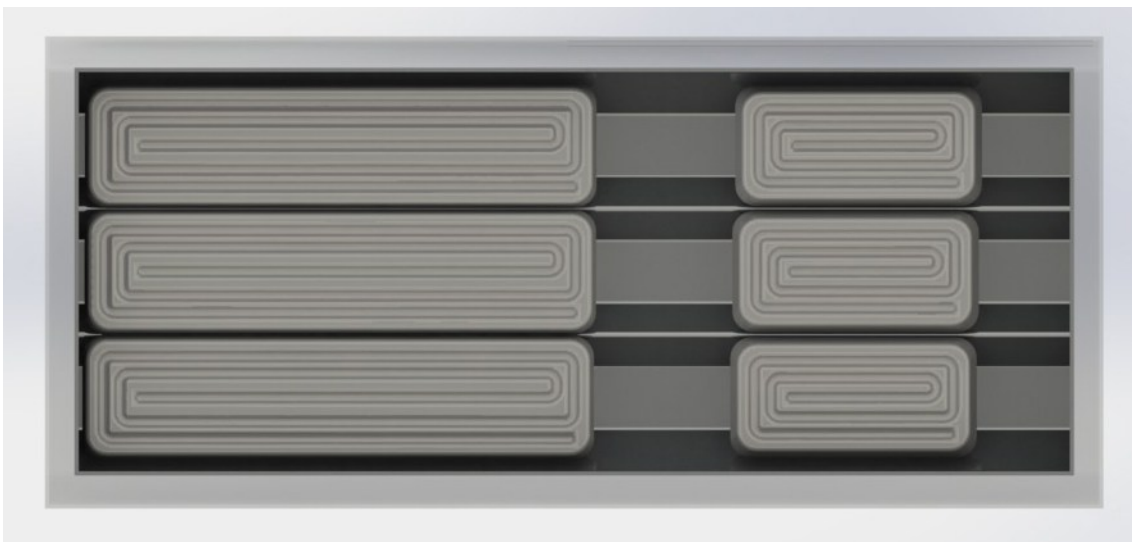
Obr. 32: Rozložení zářičů v peci
