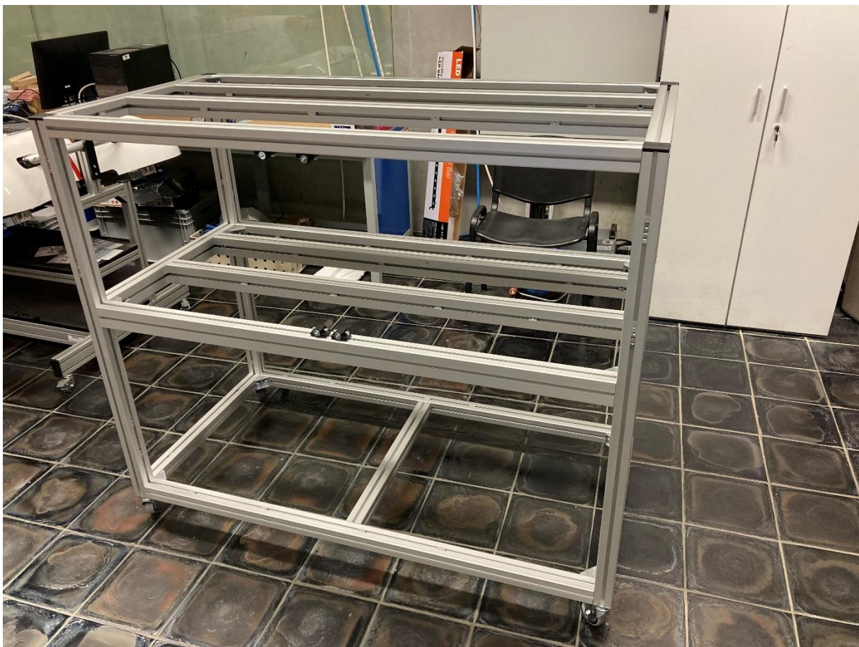
Obr. 30 Montáž rámové konstrukce
