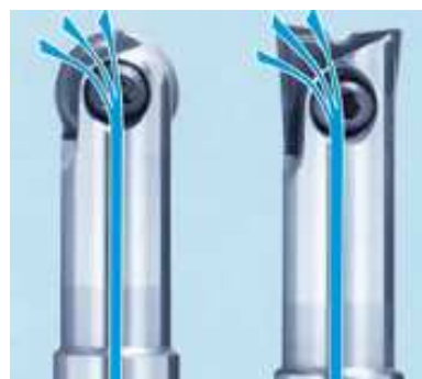
Obr.22 Vnitřní chlazení přes drážky břitových destiček [18] .
