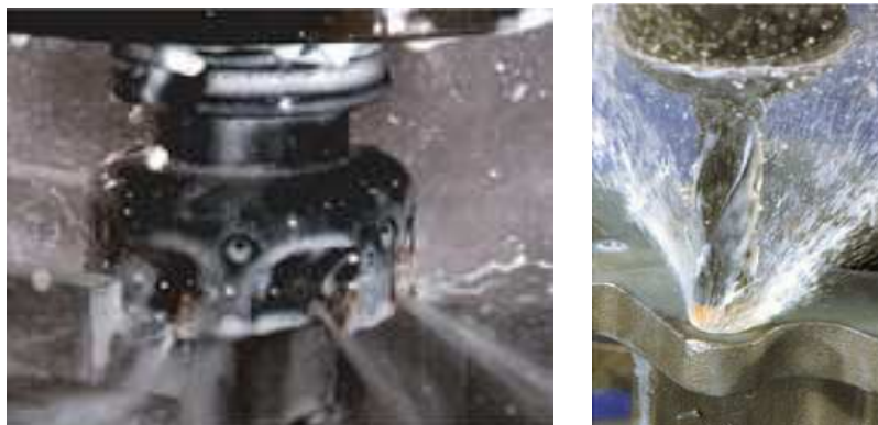
Obr.18, 19 Příklad aplikace vysokotlakého chlazení u nástrojů [18] .
