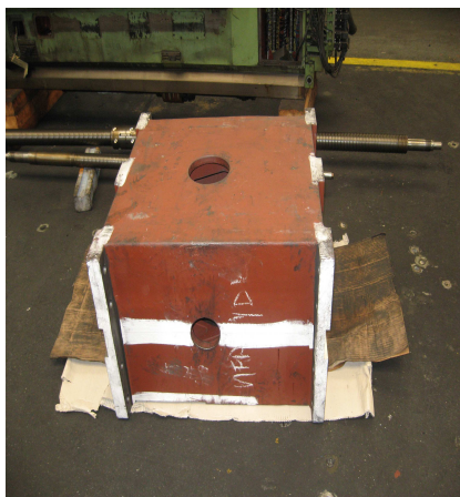
Obr.69 Pohled na částečně obrobenu součást - po hrubování.
