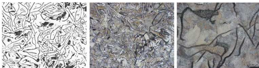
Obr.2 Mikrostruktura matrice (zleva) feritické, feriticko-perlitické a perlitické [7] .
