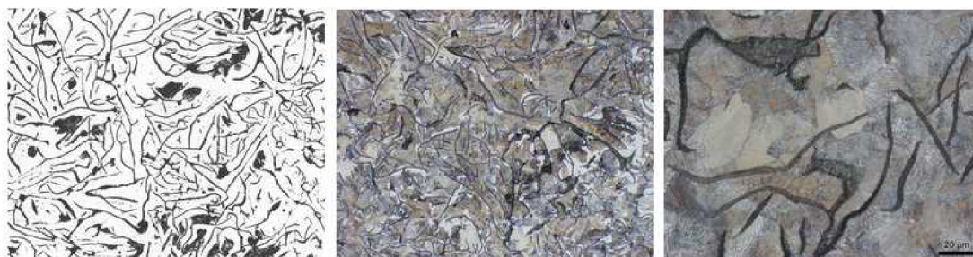
Obr.2 Mikrostruktura matrice (zleva) feritické, feriticko-perlitické a perlitické [7] .
