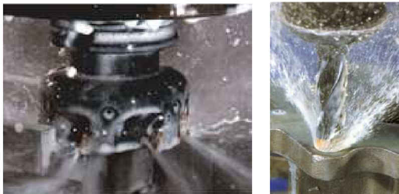
Obr.18, 19 Příklad aplikace vysokotlakého chlazení u nástrojů [18] .
