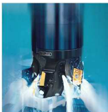
Obr.23 Fréza firmy Stellram s vnitřním chlazením [18] .
