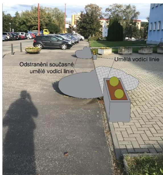
Obrázek 217 Úprava umělých vodících linií
