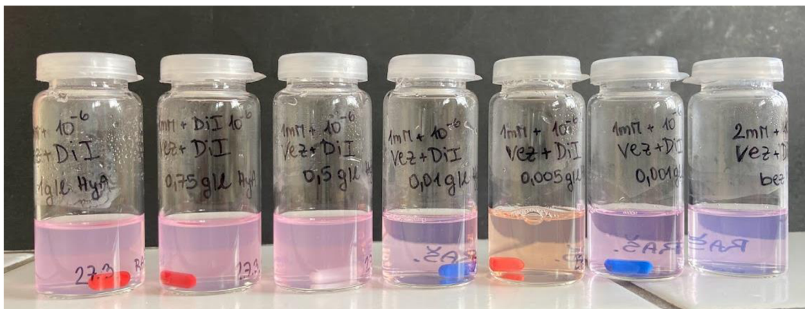
Obrázek 32: Koncentrační řada hyaluronanu s cIPA a fluorescenční sondou DiI po 24 hodinách od přípravy. Od nejvyšší koncentrace HyA (1 g/l), po nejnižší (bez HyA). Pozn.: barevné předměty na dně vialů představují magnetická míchačková tělíska.
