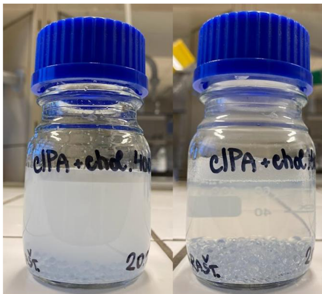
Obrázek 31: Připravené vezikulární systémy s koncentrací cholesterolu 43 mol.%. Vlevo systémy před sonifikací, vpravo po sonifikaci.
