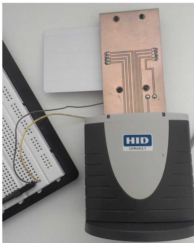
Obr. 3.4: Zapojení proudové sondy a měřicí DPS do čtečky karet.
