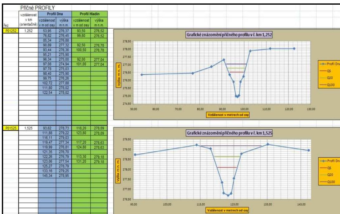
(Obr. 8.8. Vlastní grafické zpracování příčných profilů ř. km 1,252 a 1,525).
