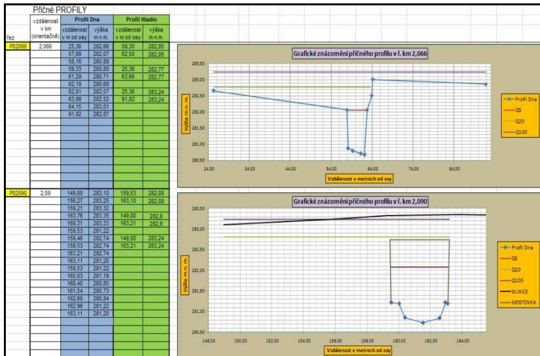
(Obr. 8.12. Vlastní grafické zpracování příčných profilů ř. km 2,066 a 2,090).
