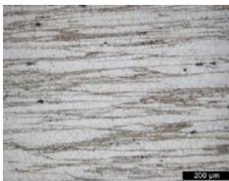
Obr. 4.19: Mikrostruktura slitiny AZ91 po extruzi [53]
