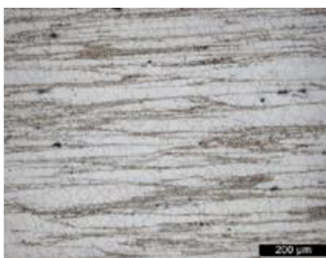
Obr. 4.19: Mikrostruktura slitiny AZ91 po extruzi [53]
