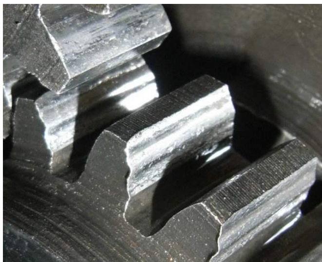
Obr. 36 Poškození plastickou deformací [40]
