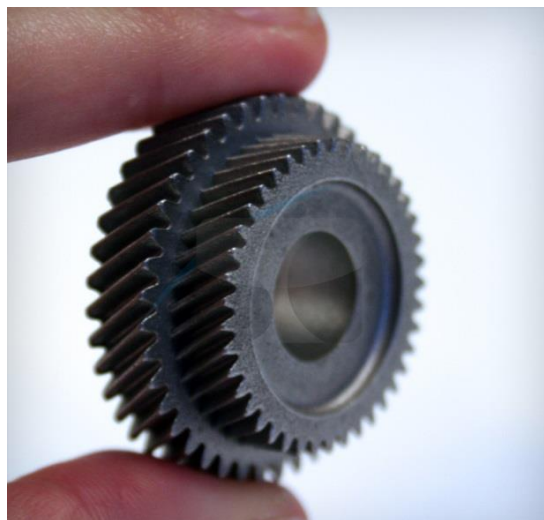
Obr. 21 Kovové ozubené kolo vyrobené metodou SLS [25]
