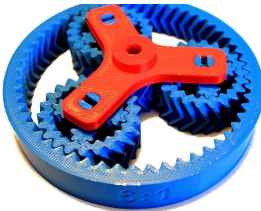
Obr. 23 Planetová převodovka vyrobená metodou FDP [27]
