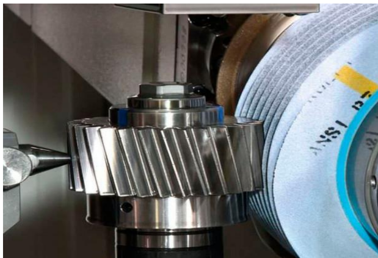
Obr. 27 Broušení ozubeného kola kotoučem ve tvaru evolventního šneku [31]
