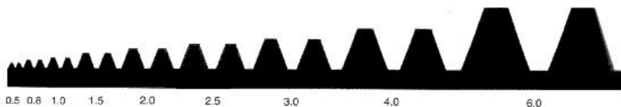
Obr. 11 Různé hodnoty velikosti modulu m [15]
