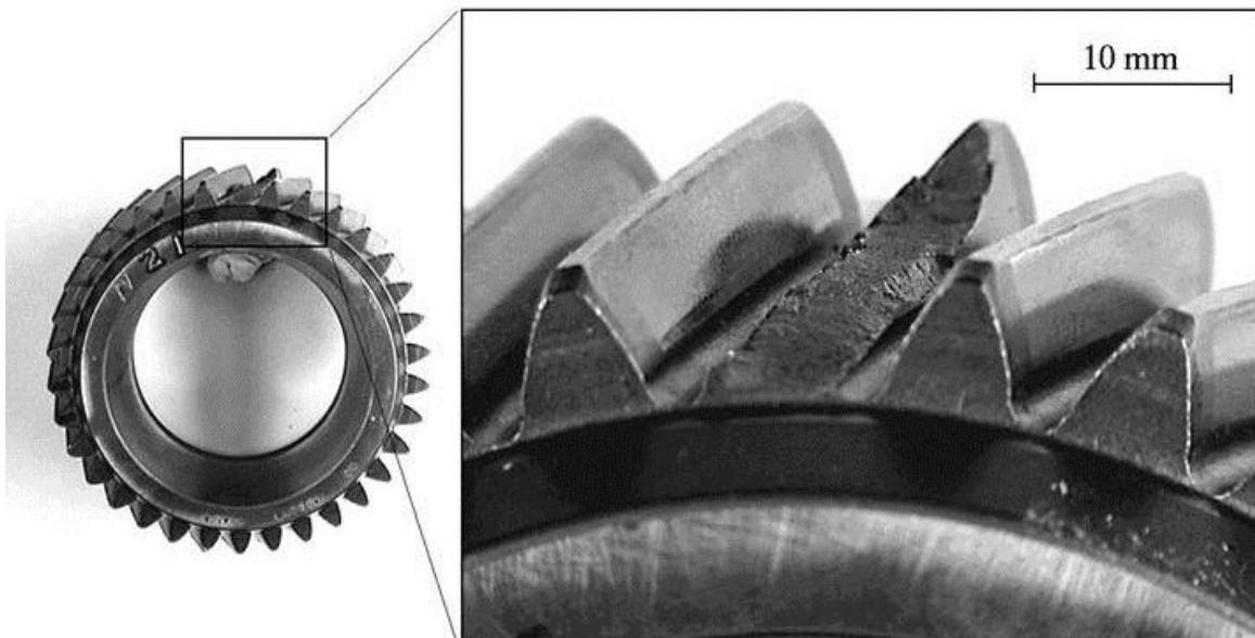
Obr. 41 Lom zubu šikmého ozubení [45]
