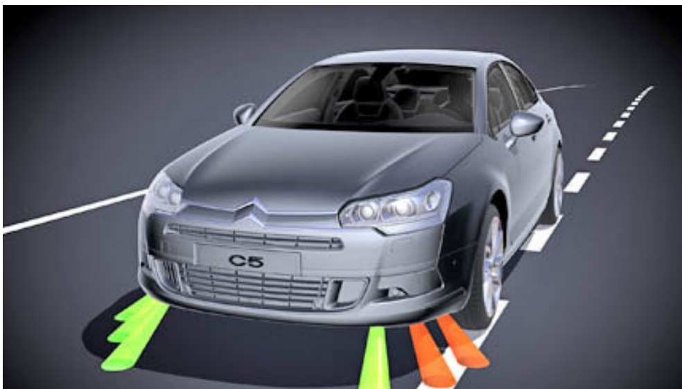
Obrázek 1: AFIL systém u automobilu Citroën C5
