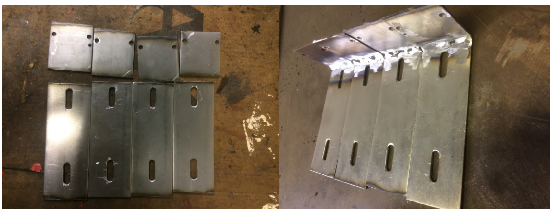
Obrázek 3.3. Fotografie z výroby spojovacích dílů mezi lavicí a kolejnicovou základnou.
