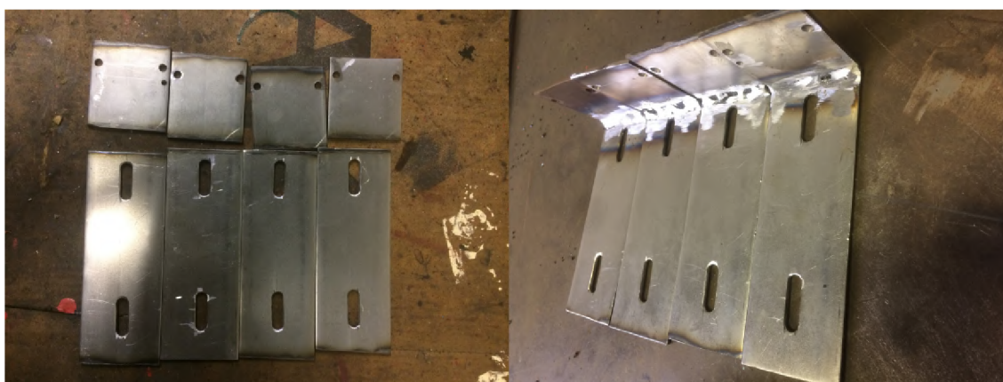
Obrázek 3.3. Fotografie z výroby spojovacích dílů mezi lavicí a kolejničovou základnou.
