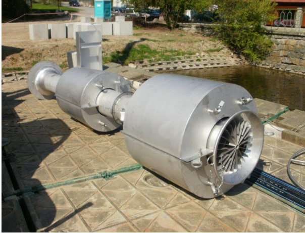
Obr. 21: Aerační věže ( http://www.asio.cz/cz/aeracni-veze )
