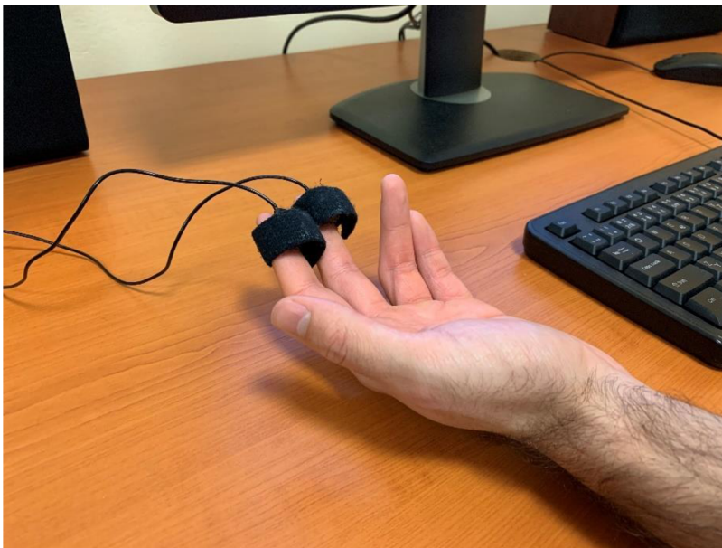
Obrázek č. 7: Zapojení elektrod.
