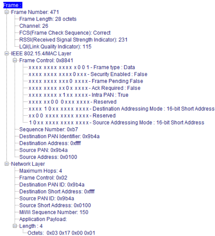
Obrázek 4.4: Struktura datového paketu vyobrazeném v prostředí Wireless Development Studio
