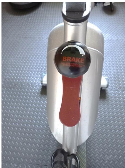
Obr. 3 - Kolík pro úpravu zátěže (otočení vpravo vlevo) a brzda (BRAKE) po stlačení
