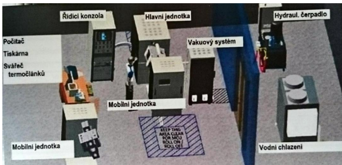
Obr. 12 Rozmístění komponentů na pracovišti Gleeble [5]
