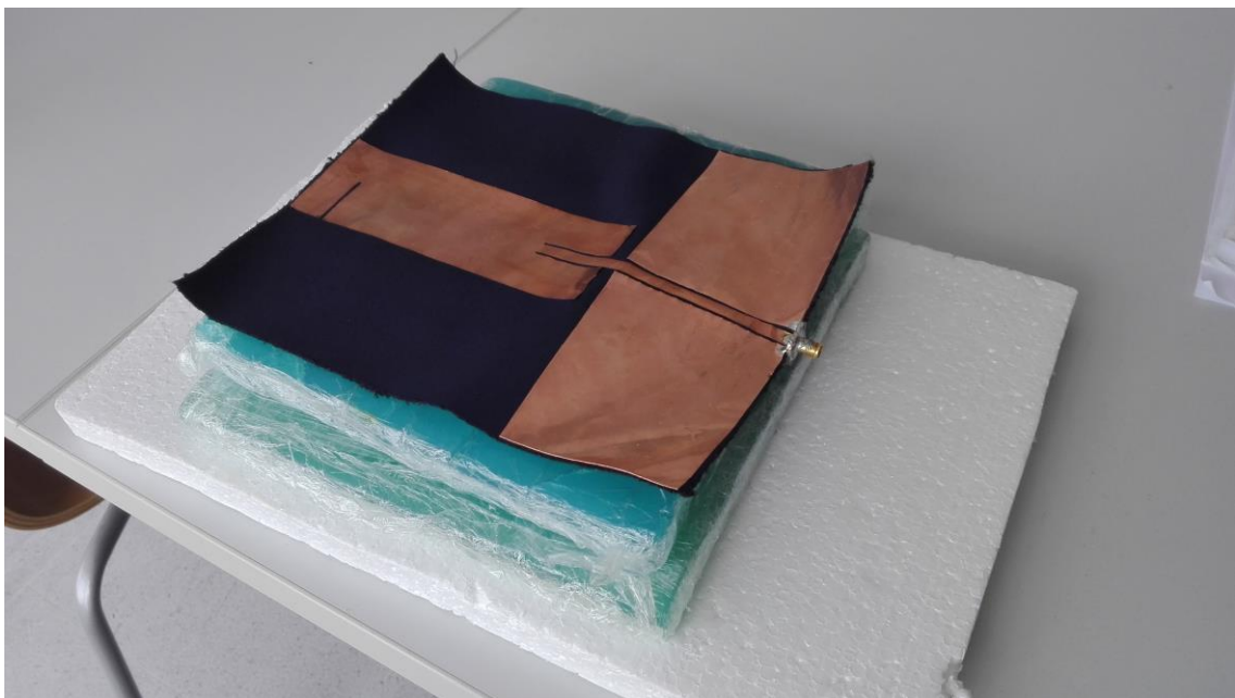
Obr. II Měření odrazu antény položené na agaru
