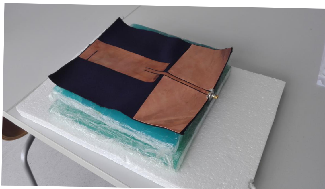
Obr. II Měření odrazu antény položené na agaru
