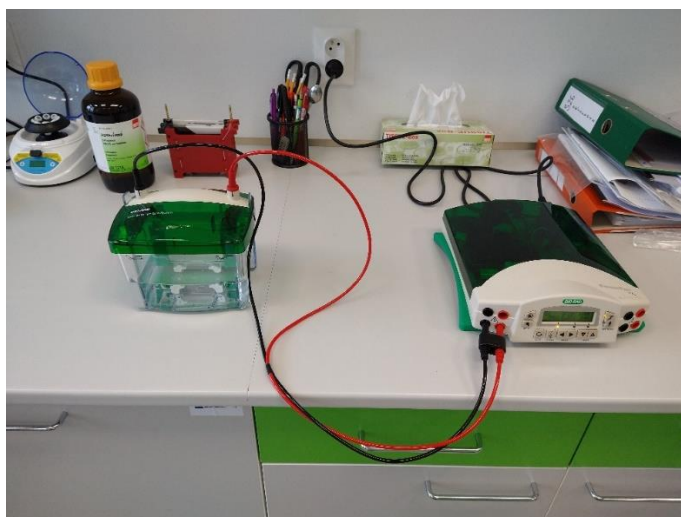
Obrázek 27: Přístroj na separaci proteinů: Mini - Protean® Tetra Cell (Bio-Rad, USA)
