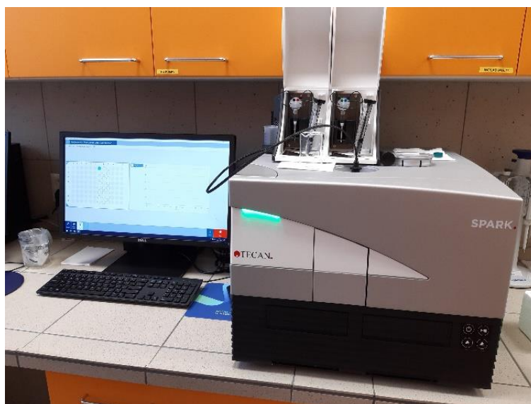
Obrázek 24: Příklad přístroje, kterým jsme měřili aktivitu SOD (Spark®, Tecan)
