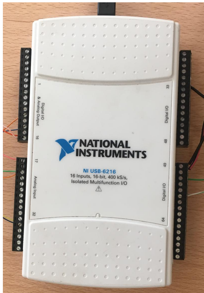
Obrázek 17: Fotografie použitého měřicího modulu NI USB-6216. Zdroj: vlastní.
