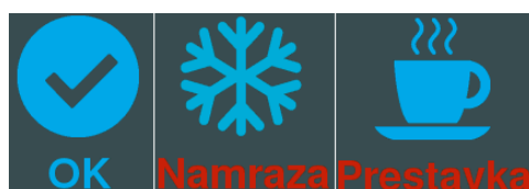
Obr. 7.5: Ikony pro vizuální upozornění řidiče. Zleva: vše je v pořádku ( iAlarm = 0 ), upozornění na námrazu (ikona se objeví pokud vnější teplota klesne pod 0\text{ }^{\circ}\text{C} , iAlarm = 1 ), přestávka (ikona momentálně není implementovaná, iAlarm = 2 )
