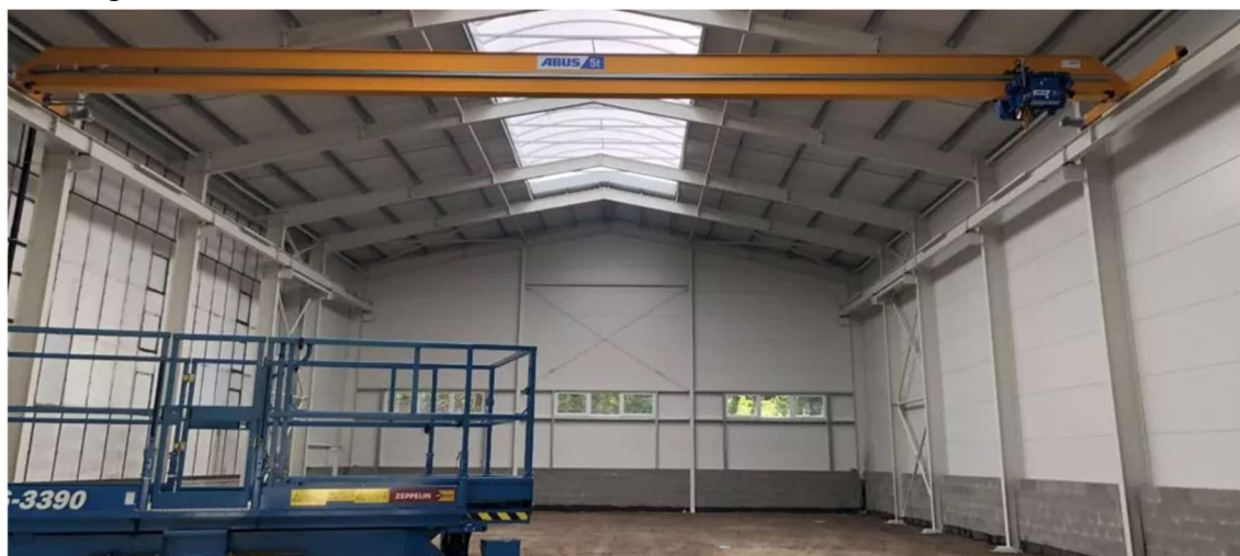
Obr. 19 - Mostový jeřáb - převzato z [36], upraveno
