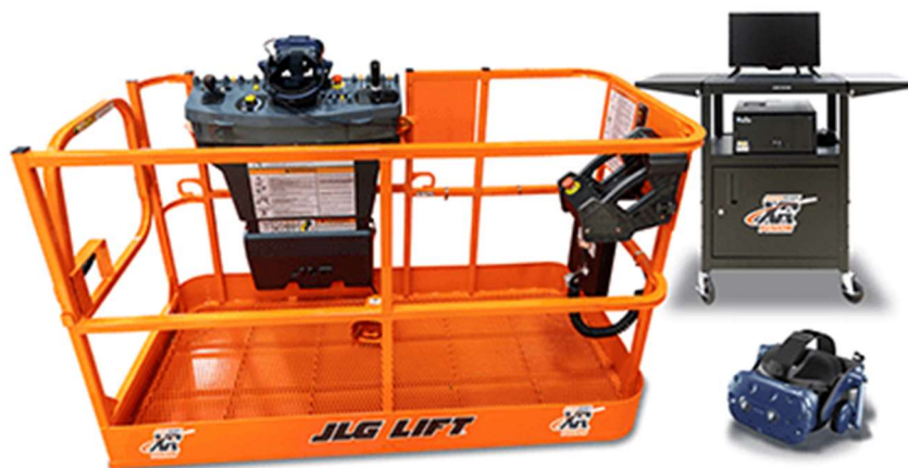
Obr. 10 - Trenažér pro výuku obsluhy jeřábu - převzato z [25], upraveno
