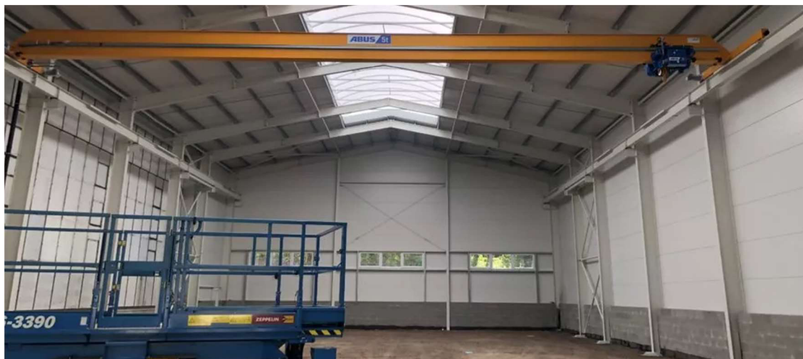
Obr. 19 - Mostový jeřáb - převzato z [36], upraveno
