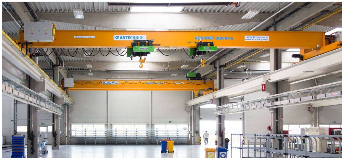
Obr. 20 - Dva mostové jeřáby na těžce kolejnici - převzato z [37], upraveno
