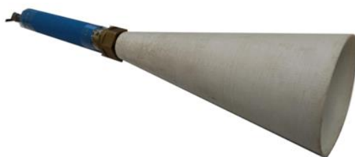
Obr. 4-3 Bezkontaktní senzor akustické emise s nástavcem
