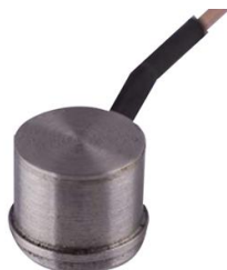
Obr. 4-4 Kontaktní senzor akustické emise MDK13
